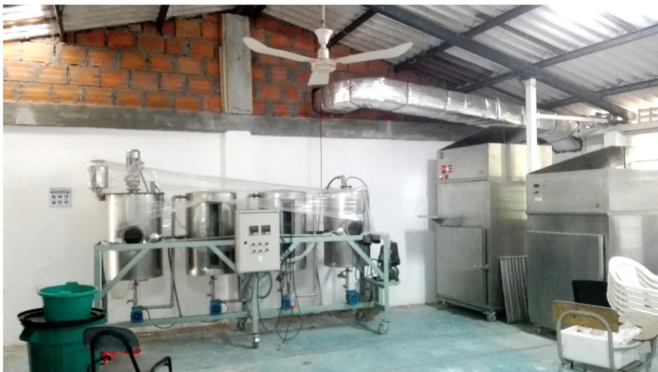
Planta piloto para producción de biodiesel
